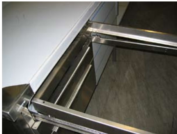
Snu skuffinnsatsen tilbake til glideskinna. Styretappene i bakkant treffer da de bakre hullene.
